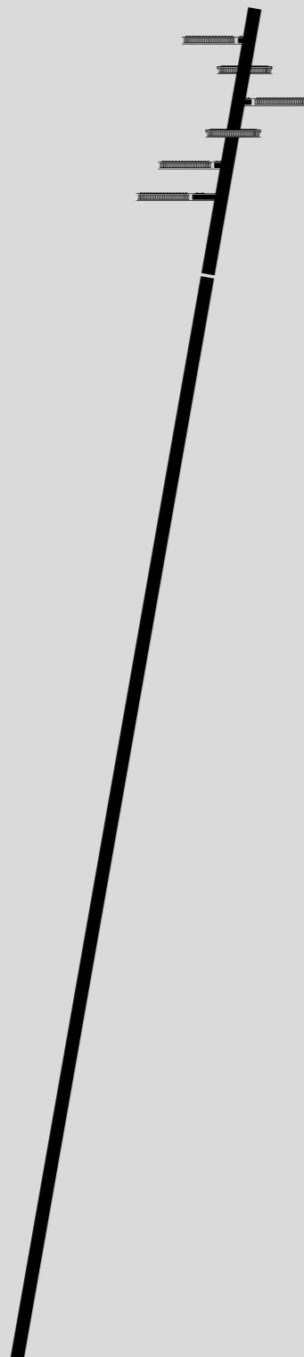
Matar éclairage en tête avec bras Configuration de la tour d'éclairage h 13 m
